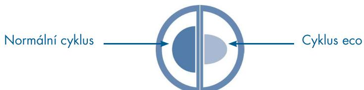
Pokud se standardní nastavení spláchnutí ukáže jako nedostatečné (např. při nízkém tlaku přívodu vody), je možné jeho délku prodloužit.
